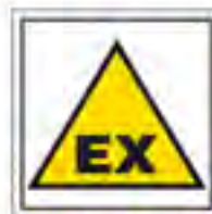
ZONA CON RIESGOS DE ATMÓSFERAS EXPLOSIVAS
